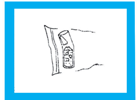
3. On doit casser le goulot de l'ampoule dans le tube plastique.
